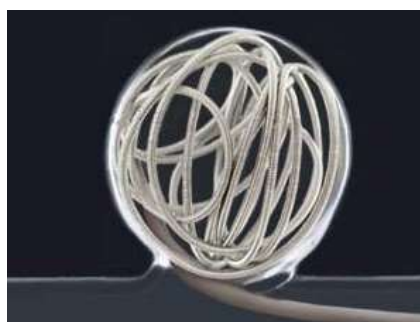
αSpiral (φ10 mm × L 30cm) in un modello di aneurisma 10 mm
